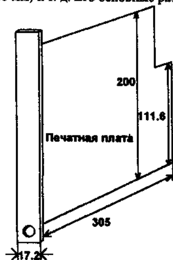
Рис. 2. Габариты модуля КАМАК шириной 1М
